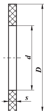
Рис. 1-5б. Прокладка из пластины резиновой листовой типа 1 по ГОСТ 7338-90 (исполнение Д по ГОСТ 15180-86)
